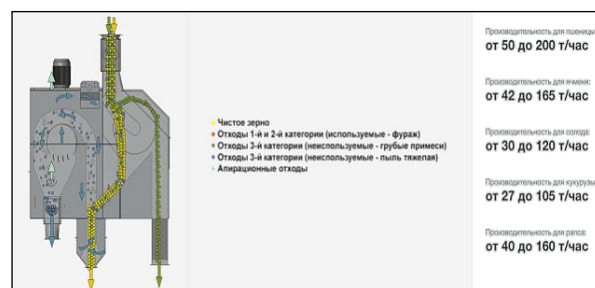
Рисунок 2. Внешний вид и устройство зерноочистительной машины NEOGRAIN
