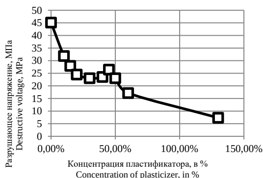
Рисунок 3. Зависимость разрушающего напряжения пленки из ПВС от количества, вводимого в нее пластификатора
