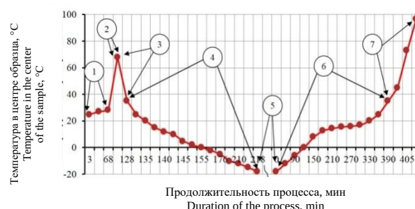
1 – замес, брожение, разделка, формование, расстойка (тестовой заготовки массой 0,07 кг); 2 – выпечка (до готовности на 70–75 %); 3 – охлаждение (до 35 °С); 4 – замораживание; 5 – хранение; 6 – размораживание; 7 – допекание 1 – kneading, fermentation, cutting, molding, proofing (of a test billet weighing 0,07 kg); 2 – baking (until 70–75 % ready); 3 – cooling (up to 35 °C); 4 – freezing; 5 – storage; 6 – defrosting; 7 – baking
