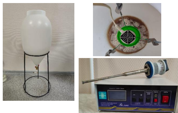
Рисунок 2. Общий вид экспериментальной установки для исследования процесса ультразвуковой экстракции Figure 2. General view of the experimental setup for studying the ultrasonic extraction process
