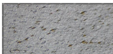
Рисунок 4. Разрушение лакокрасочного покрытия и коррозия после стерилизации в 3% растворе пищевой соли Figure 4. Destruction of paint coating and corrosion after sterilization in 3% solution of edible salt
