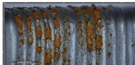
Рисунок 3. Разрушение лакокрасочного покрытия и коррозия после стерилизации в дистиллированной воде
