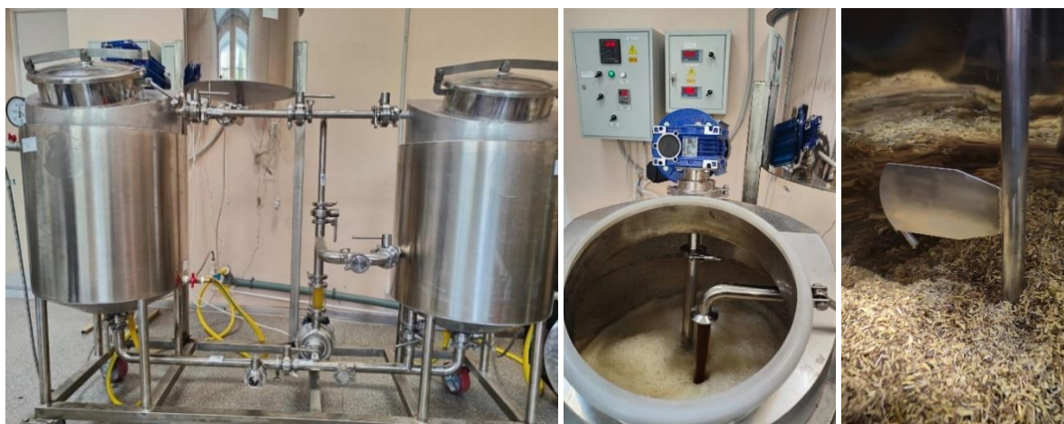
Рисунок 1. Двухкорпусная экстракционная установка с СВЧ-обработкой экстракционной смеси Figure 1. Double-shell extraction unit with microwave treatment of the extraction mixture
