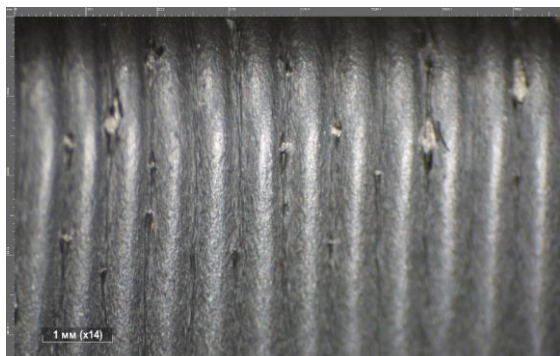
Рисунок 2. Разрывы лакокрасочного покрытия в зоне морщин
