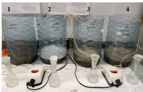
Рисунок 1. Установка по оценке влияния ПВС на биоценоз активного ила
