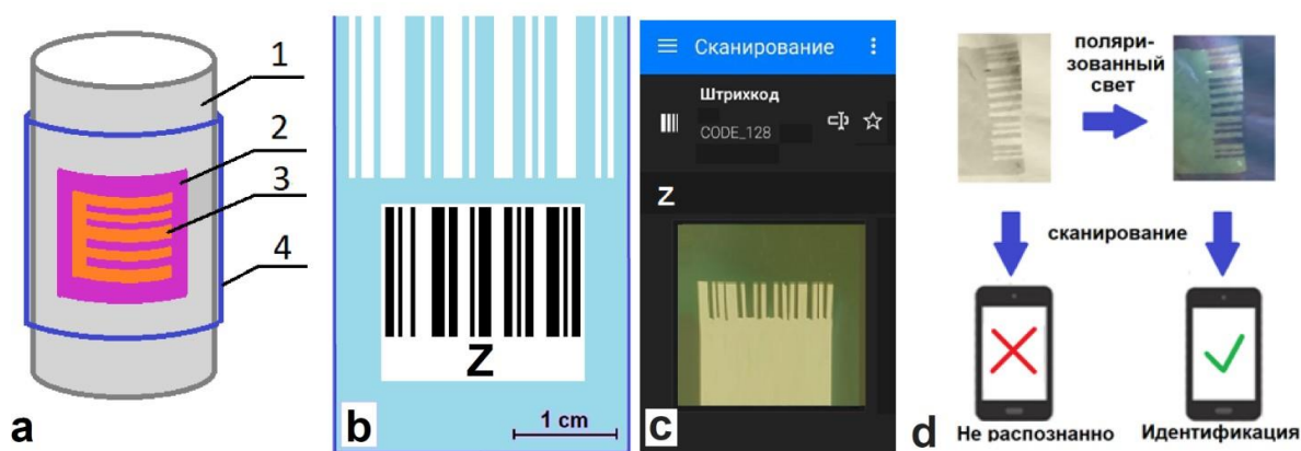
Рисунок 7. а – схема многослойной термоусадочной этикетки из прозрачной пленки поливинилхлорида (1) с «вкладышем» из двух слоев пленки ВОРР (3,4) на стальной банке с полированной поверхностью; б – штриховой код, высеченный из пленки ВОРР с информационной меткой «Z»; в – окно русской программы «QR-сканер» с результатом распознавания штрих-кода «Z» в поляризованном свете
