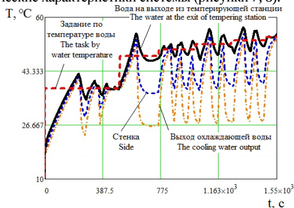
Рисунок 7. Динамические характеристики темперирующей станции с корректировкой задания
