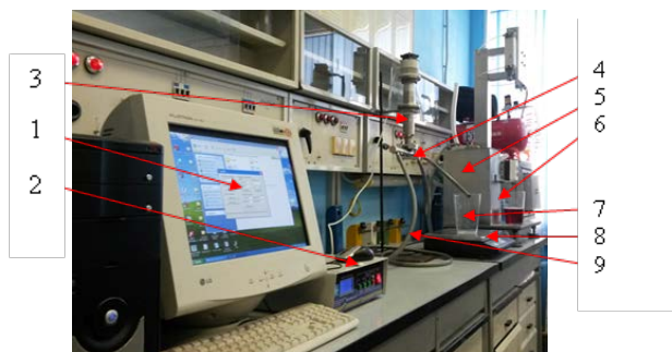
Рисунок 2. Общий вид установки. 1. Компьютер для настройки ультразвукового генератора; 2. Ультразвуковой генератор; 3. Ультразвуковой излучатель; 4. Фильтр; 5. Машина розлива МРп-1/2; 6. Отфильтрованный продукт; 7. Фильтрат; 8. Контрольные весы; 9. Продуктопровод
