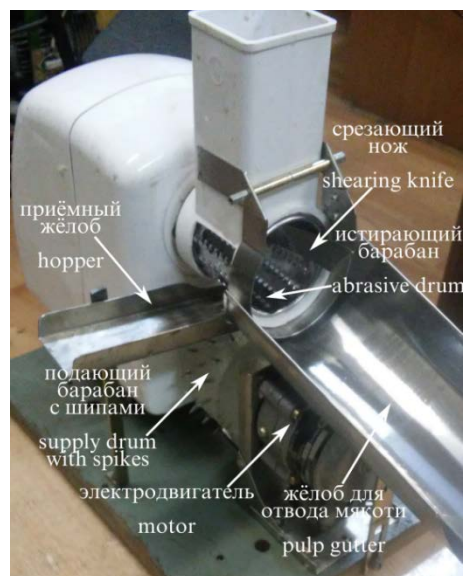
Рисунок 1. Экспериментальная установка для отделения корки от дыни
